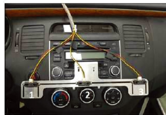
<발명 실시예에 따른 운전자 위험도 추정시스템 중 적외선 센서가 차량 센터 콘솔에 배치된 예시>
